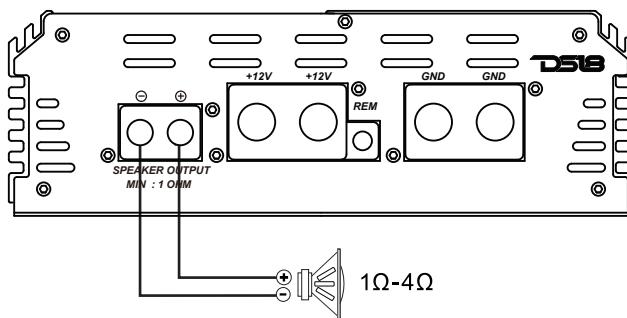
**Dual speaker wire connection / Conexión con doble cable de altavoz****DUAL SPEAKER CONNECTION**CONEXIÓN DE
