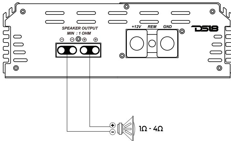
**SPEAKER OUT CONNECTIONS / CONEXIONES DE SALIDA DE ALTAZO****SMD-200.4AB / SMD-300.4AB / SMD-500.4AB****4 Channels speaker connection / Conexión de altavoz de 4 canales****STEREO MODE**
