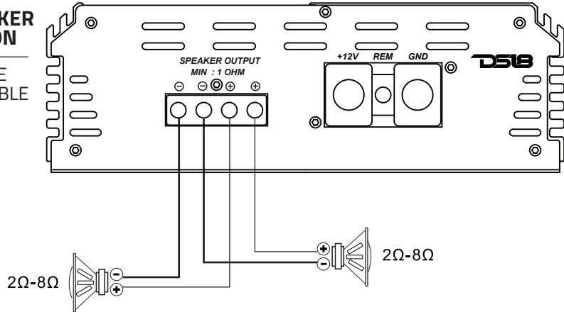
**SINGLE SPEAKER CONNECTION**CONEXIÓN DE UN
