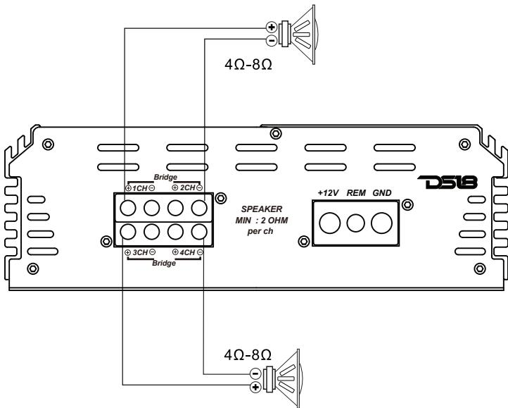
**SPEAKER OUT CONNECTIONS / CONEXIONES DE SALIDA DE ALTAZO****SMD-2800.5**
