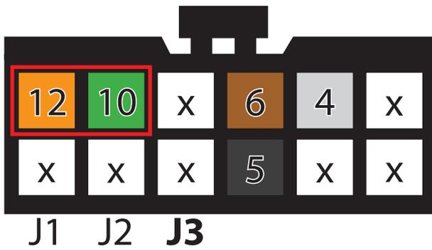
Verbinden Sie J1 · 12 (orange) mit J2 · 10 (grün). Entfernen Sie Kabelbrücke J3 (violett)
