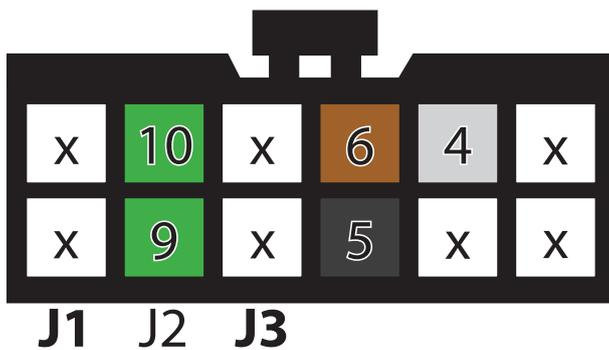
Entfernen Sie die Kabelbrücke J1 (orange) und J3 (violett)
